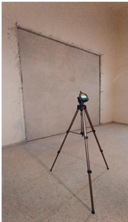
**Fotografía 1: Montaje de ensayo en cámaras de transmisión (A-3541)**
