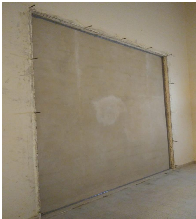
Fotografía 1: Montaje de ensayo en cámaras de transmisión (A-3538)
